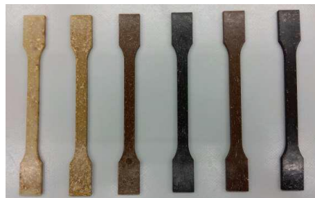
【食品残渣物とPPを 配合した試験片】
